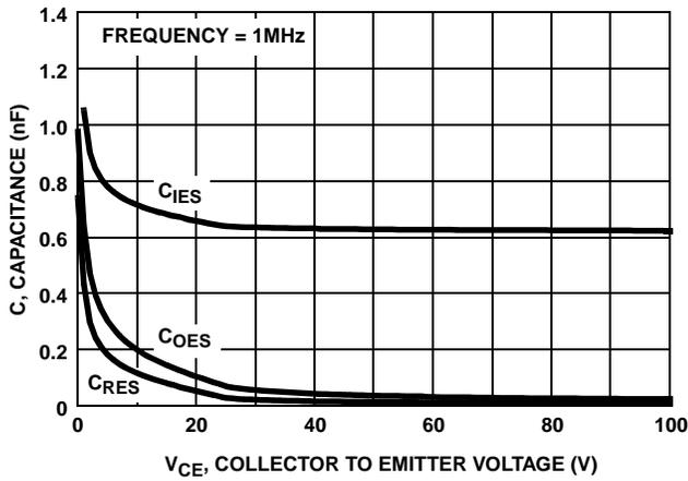
FIGURE 17. CAPACITANCE vs COLLECTOR TO EMITTER VOLTAGE
