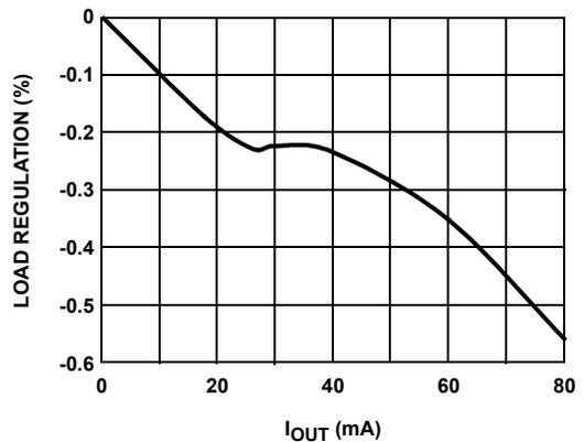
FIGURE 6. V<sub>ON</sub> LOAD REGULATION
