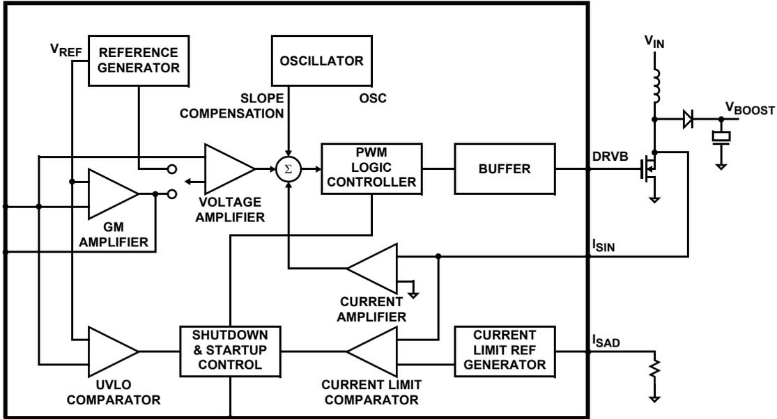
FIGURE 25. FUNCTION DIAGRAM OF THE BOOST CONTROLLER
