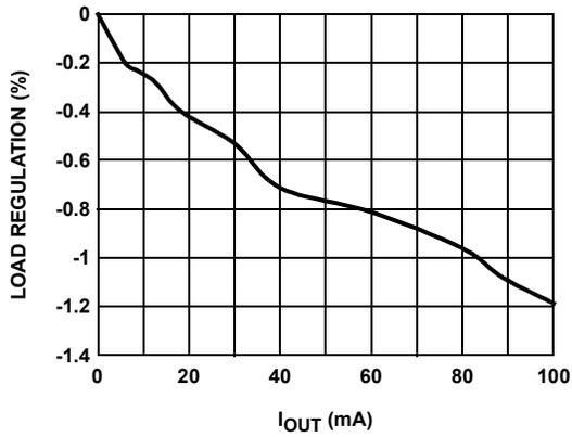
FIGURE 7. V<sub>OFF</sub> LOAD REGULATION
