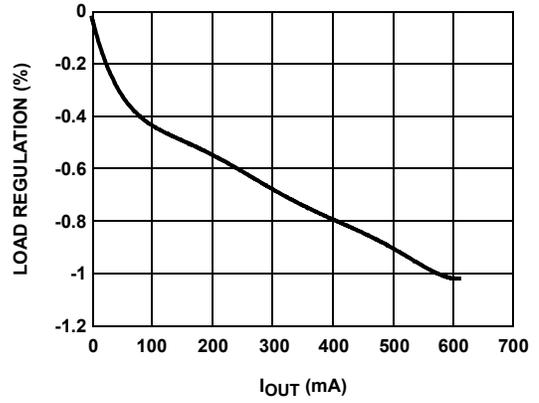
FIGURE 8. V<sub>LOGIC</sub> LOAD REGULATION
