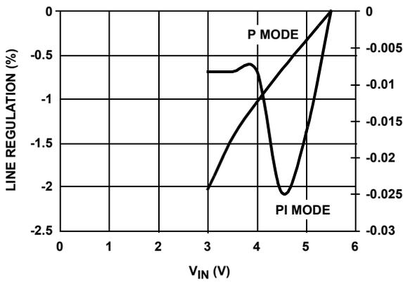
FIGURE 3. V<sub>BOOST</sub> LINE REGULATION
