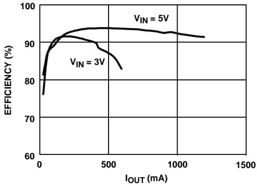
FIGURE 1. V<sub>BOOST</sub> EFFICIENCY vs I<sub>OUT</sub> (PI MODE)
