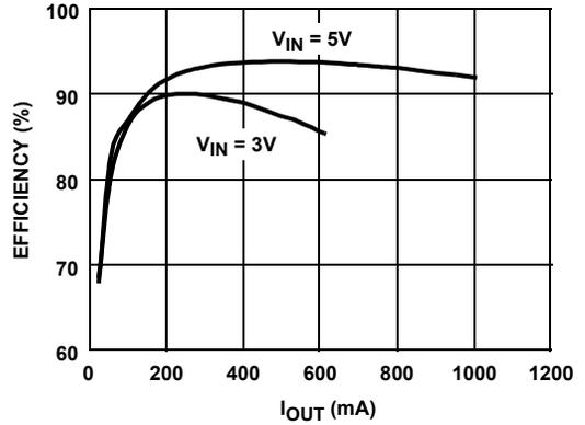
FIGURE 2. V<sub>BOOST</sub> EFFICIENCY vs I<sub>OUT</sub> (P MODE)
