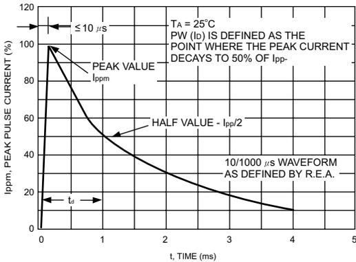
FIG.8- PULSE WAVEFORM
