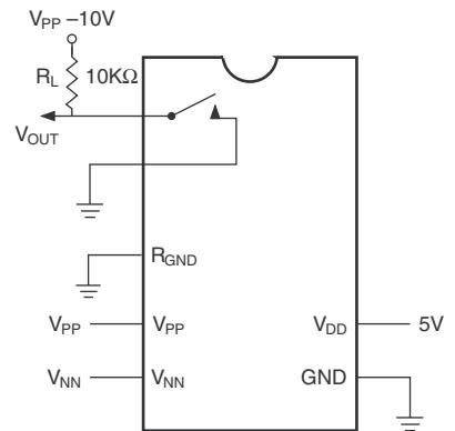
T<sub>ON</sub>/T<sub>OFF</sub> Test Circuit
