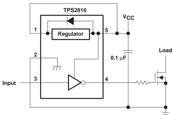
Figure 20.  $V_{CC} < 14$  V
