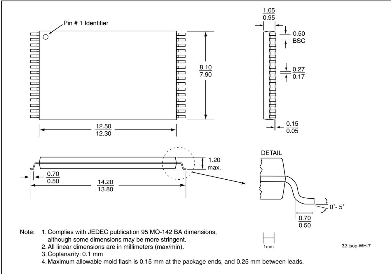
**32-LEAD THIN SMALL OUTLINE PACKAGE (TSOP) 8MM X 14MM**
