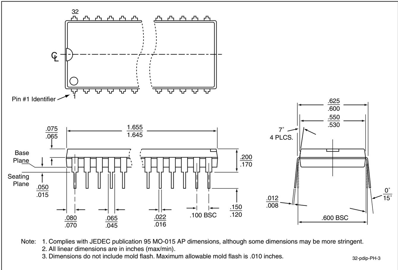
**32-PIN PLASTIC DUAL IN-LINE PINS (PDIP)**
