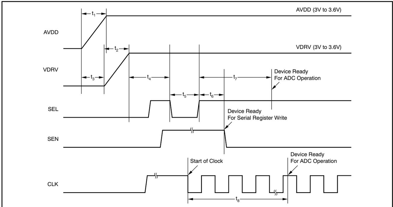
NOTE:  $10\mu\text{s} < t_1 < 50\text{ms}$ ;  $10\mu\text{s} < t_2 < 50\text{ms}$ ;  $-10\text{ms} < t_3 < 10\text{ms}$ ;  $t_4 > 10\text{ms}$ ;  $t_5 > 100\text{ns}$ ;  $t_6 > 100\text{ns}$ ;  $t_7 > 10\text{ms}$ ; and  $t_8 > 100\mu\text{s}$ .
