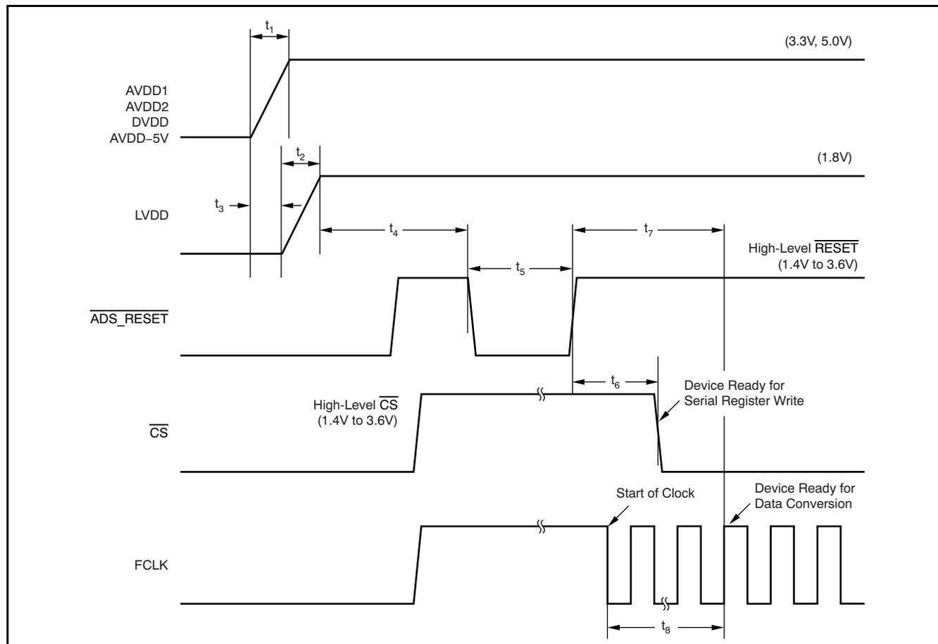
$10\mu\text{s} < t_1 < 50\text{ms}$ ,  $10\mu\text{s} < t_2 < 50\text{ms}$ ,  $-10\text{ms} < t_3 < 10\text{ms}$ ,  $t_4 > 10\text{ms}$ ,  $t_5 > 100\text{ns}$ ,  $t_6 > 100\text{ns}$ ,  $t_7 > 10\text{ms}$ , and  $t_8 > 100\mu\text{s}$ .
