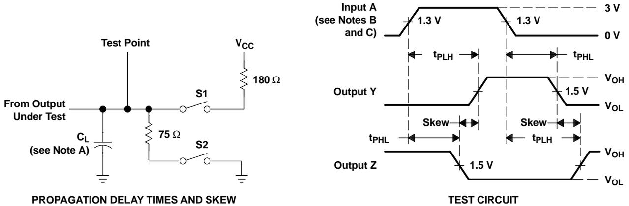
PROPAGATION DELAY TIMES AND SKEW
