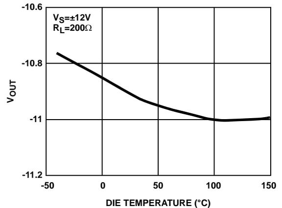
FIGURE 24. OUTPUT VOLTAGE vs TEMPERATURE
