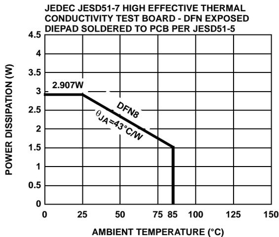
FIGURE 27. PACKAGE POWER DISSIPATION vs AMBIENT TEMPERATURE
