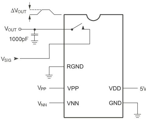
$Q = 1000\text{pF} \times \Delta V_{\text{OUT}}$
