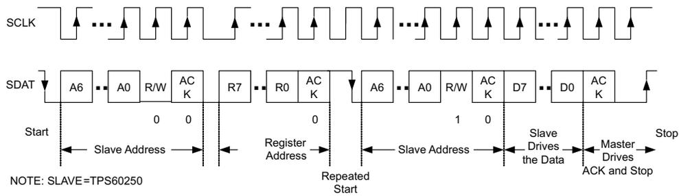
Figure 18. Serial I/F READ From TPS60250: Protocol B
