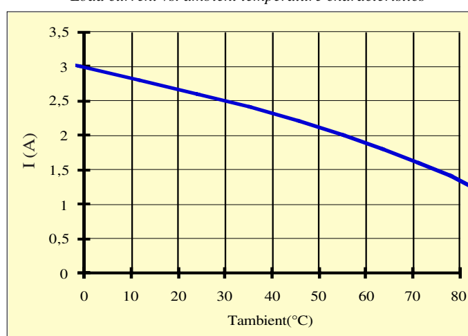
Fig. 2 : Courant en fonction de la température ambiante / Load current vs. ambient temperature characteristics
