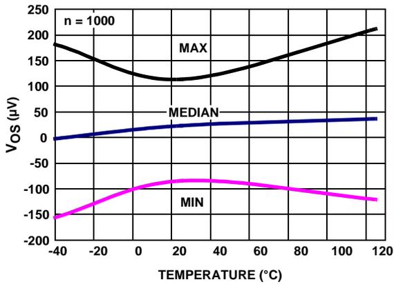
FIGURE 37. ISL28270, ISL28470  $V_{OS}$  vs TEMPERATURE,  $V_+, V_- = \pm 2.5V$
