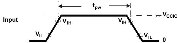
Figure 5-2. TTL-Level Inputs
