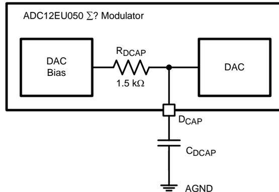
Figure 23. D<sub>CAP</sub> RC Filter
