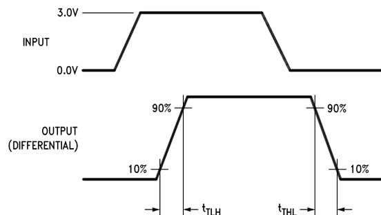
Input pulse;  $f = 1 \text{ MHz}$ , 50%;  $t_r \leq 6 \text{ ns}$ ,  $t_f \leq 6 \text{ ns}$
