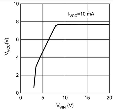
Figure 2. V<sub>CC</sub> vs V<sub>IN</sub>
