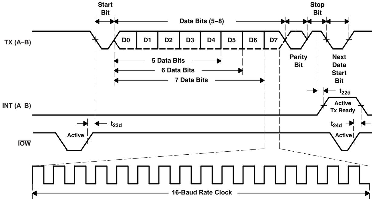
Figure 21. Transmit Timing
