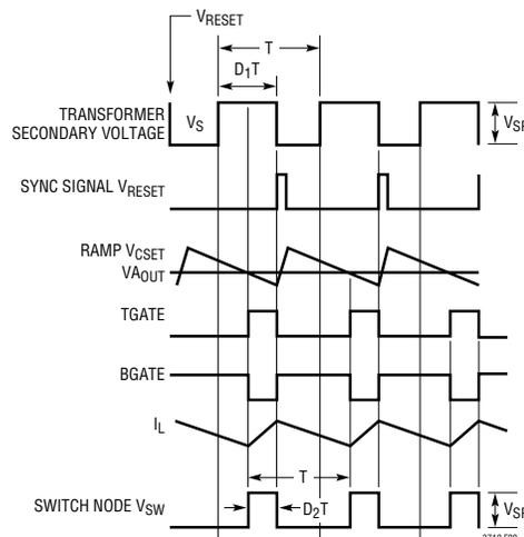
**Figure 2. Leading Edge Modulation, Trailing Edge Synchronization**
