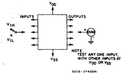
Fig. 11 – Input voltage.
