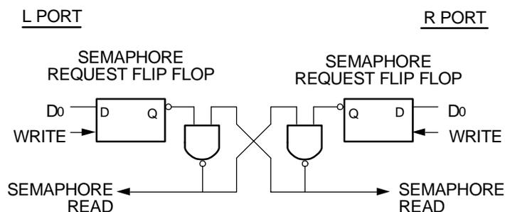
Figure 4. IDT70T35/34L (IDT70T25/24L) Semaphore Logic 5639 drw 20
