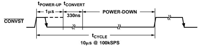
Figure 17. Automatic Power-Down
