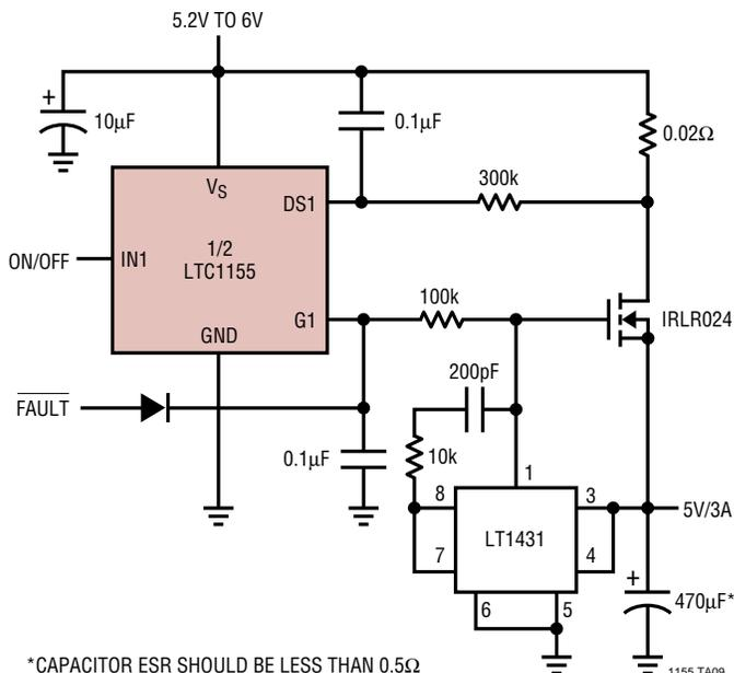
\*CAPACITOR ESR SHOULD BE LESS THAN 0.5Ω
