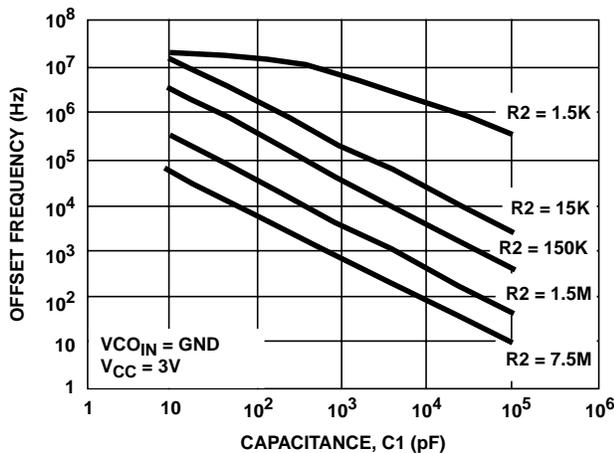
FIGURE 30. HC7046A OFFSET FREQUENCY vs R2, C1
