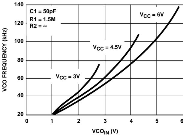
FIGURE 18. HC7046A TYPICAL VCO FREQUENCY vs  $V_{CO\_IN}$
