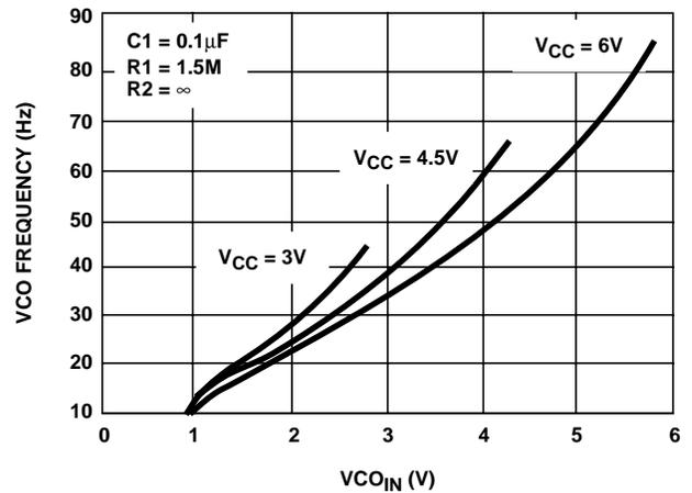
FIGURE 19. HC7046A TYPICAL VCO FREQUENCY vs  $V_{CO\_IN}$
