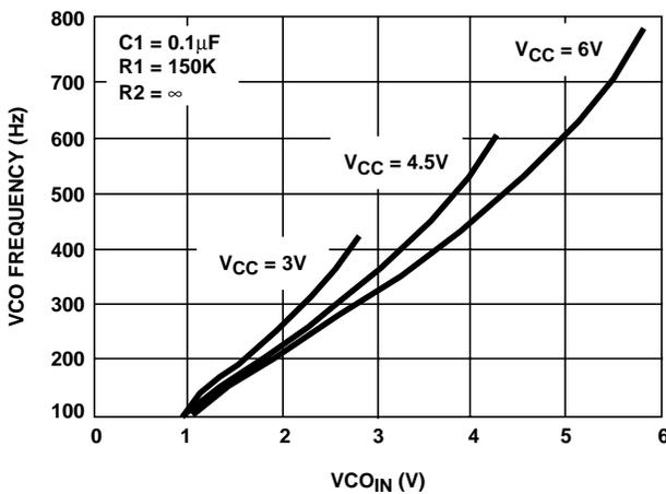
FIGURE 20. HC7046A TYPICAL VCO FREQUENCY vs  $V_{CO\_IN}$
