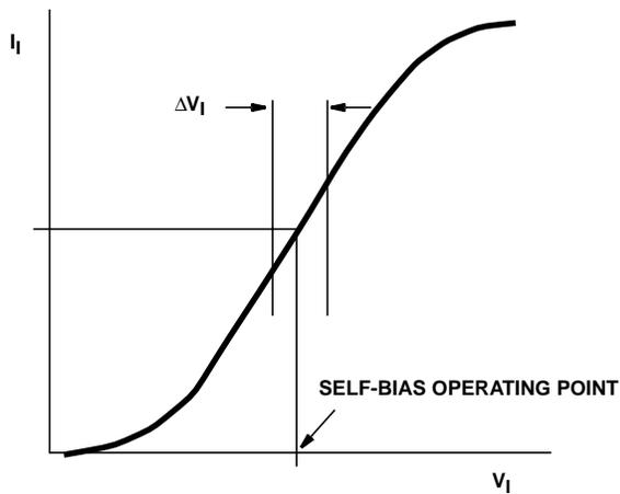
FIGURE 12. TYPICAL INPUT RESISTANCE CURVE AT SIG<sub>IN</sub>, COMP<sub>IN</sub>
