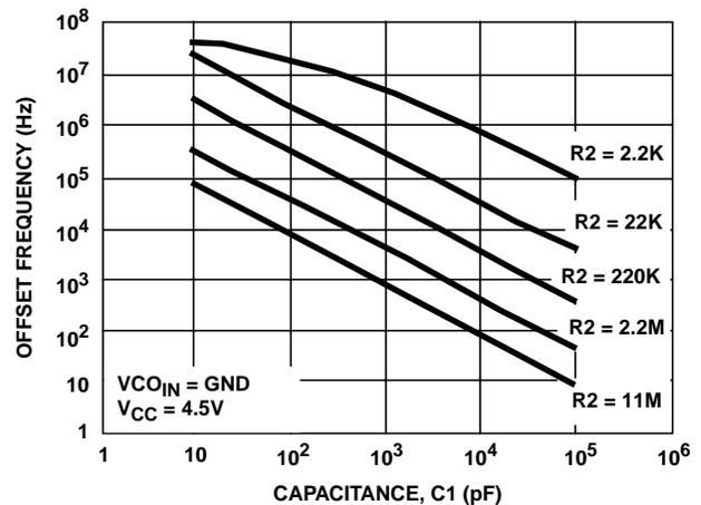
FIGURE 31. HCT7046A OFFSET FREQUENCY vs R2, C1
