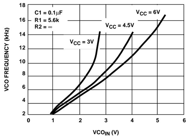
FIGURE 21. HC7046A TYPICAL VCO FREQUENCY vs  $V_{CO\_IN}$
