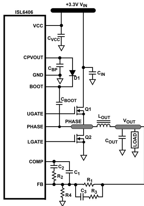
FIGURE 6. PRINTED CIRCUIT BOARD POWER PLANES AND ISLANDS
