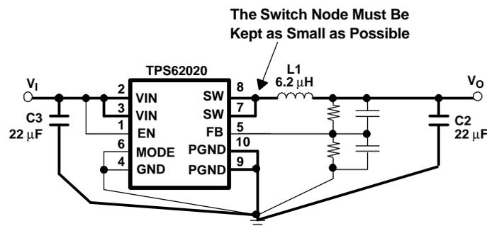
**Figure 16. Layout Diagram**
