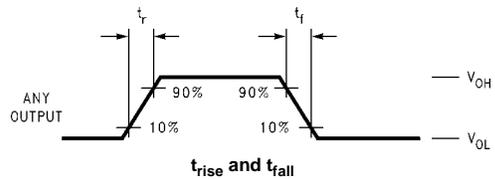
**FIGURE 2. Waveforms**
