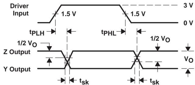
DRIVER VOLTAGE WAVEFORMS
