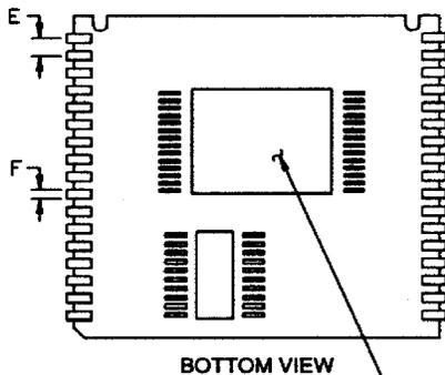
**NOTE:** DALLAS SEMICONDUCTOR RECOMMENDS THAT POWERCAP MODULE BASES EXPERIENCE ONE PASS THROUGH SOLDER REFLOW ORIENTED WITH THE LABEL SIDE UP ("LIVE-BUG").
