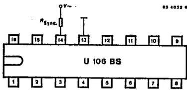
Fig. 7 Synchronisation circuit
