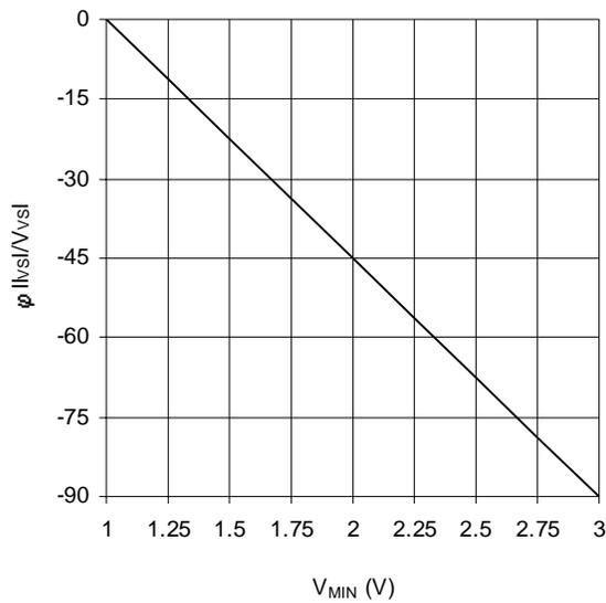
Graph 9.  $\phi_{IIS/VVSI}$  vs  $V_{MIN}$  (IR2159/IR21591)
