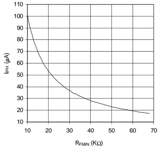
Graph 8. I<sub>IPH</sub> vs R<sub>FMIN</sub> (IR2159/IR21591)
