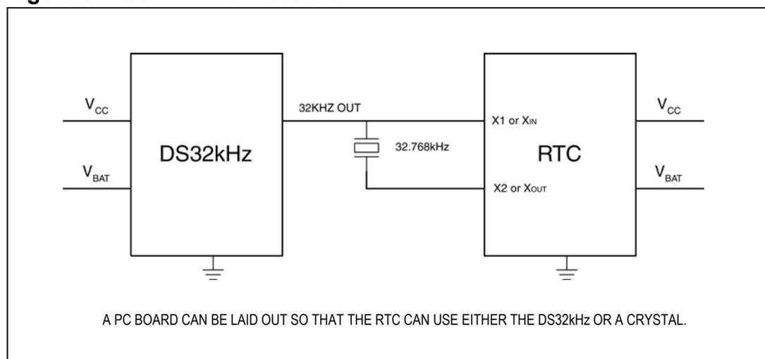
**Figure 6. DS32kHz and RTC Connections**
