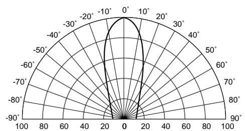
**Fig. 5B Radiation Diagram**
