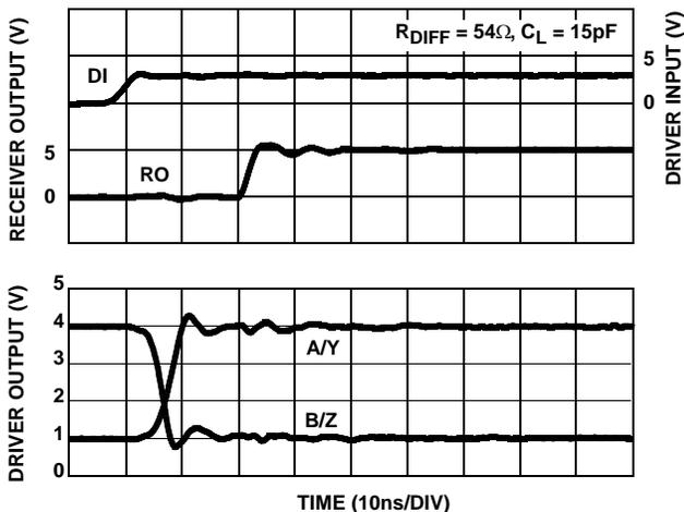
FIGURE 13. DRIVER AND RECEIVER WAVEFORMS, LOW TO HIGH
