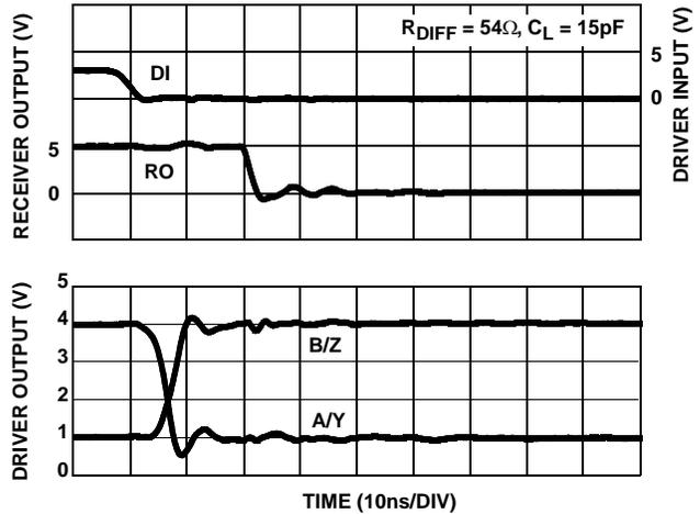
FIGURE 14. DRIVER AND RECEIVER WAVEFORMS, HIGH TO LOW
