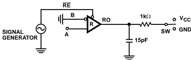
FIGURE 6A. TEST CIRCUIT
