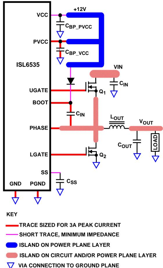
FIGURE 5. PRINTED CIRCUIT BOARD POWER PLANES AND ISLANDS
