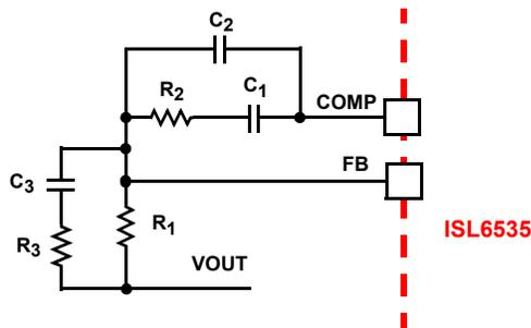
FIGURE 6. COMPENSATION CONFIGURATION FOR THE ISL6535 CIRCUIT
