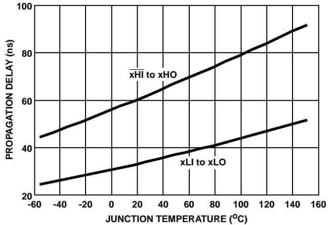
FIGURE 12. PROPAGATION DELAY
