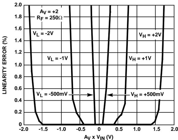
FIGURE 34. LINEARITY NEAR LIMIT VOLTAGE
