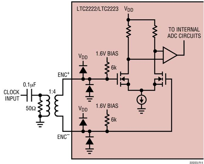
Figure 11. Transformer Driven ENC<sup>+</sup>/ENC<sup>-</sup>
