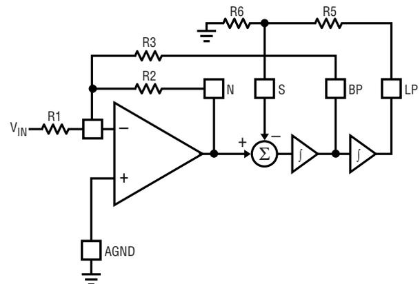
$f_o = \frac{f_{CLK}}{100(50)} \sqrt{\frac{R_6}{R_5 + R_6}}$ ;  $f_n = f_o$ ;  $Q = \frac{R_3}{R_2} \sqrt{\frac{R_6}{R_5 + R_6}}$ ;
