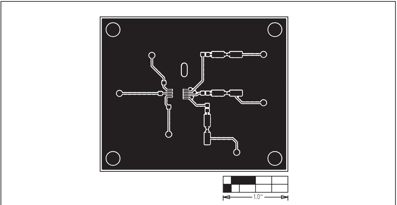
图3. MAX9500评估板PC板布局—元件层
