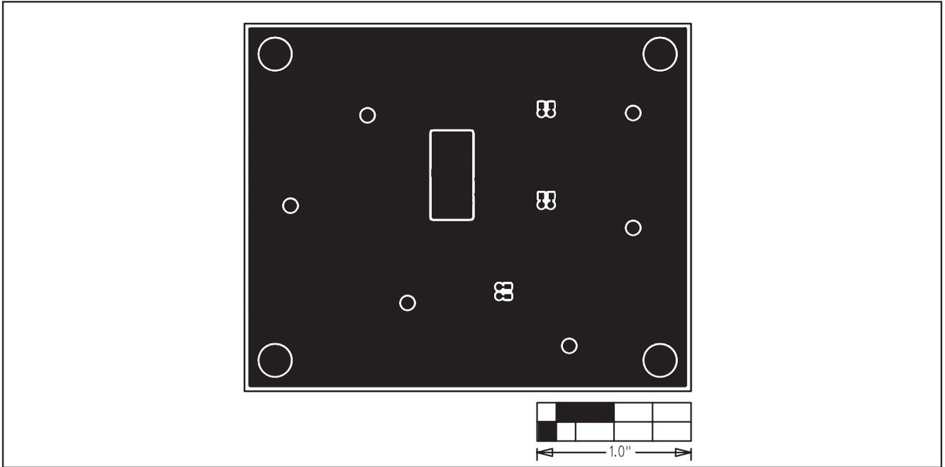
图4. MAX9500评估板PC板布局——焊接层
