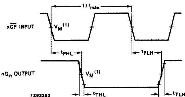
(1) HC :  $V_M = 50\%$ ;  $V_I = \text{GND to } V_{CC}$ .
