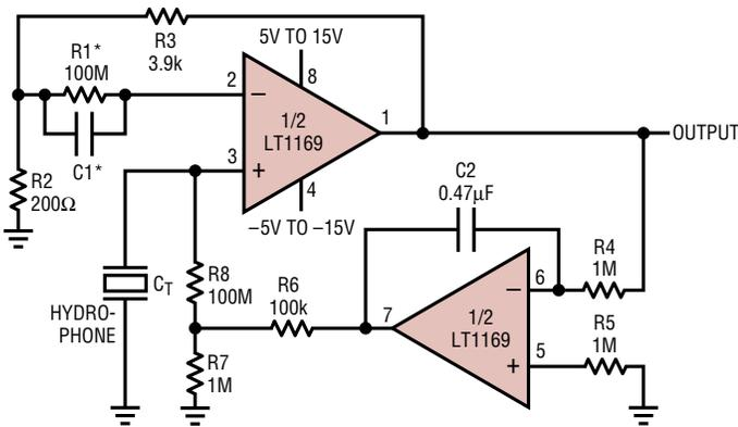
DC OUTPUT  $\leq 2.5\text{mV}$  FOR  $T_A < 70^\circ\text{C}$
