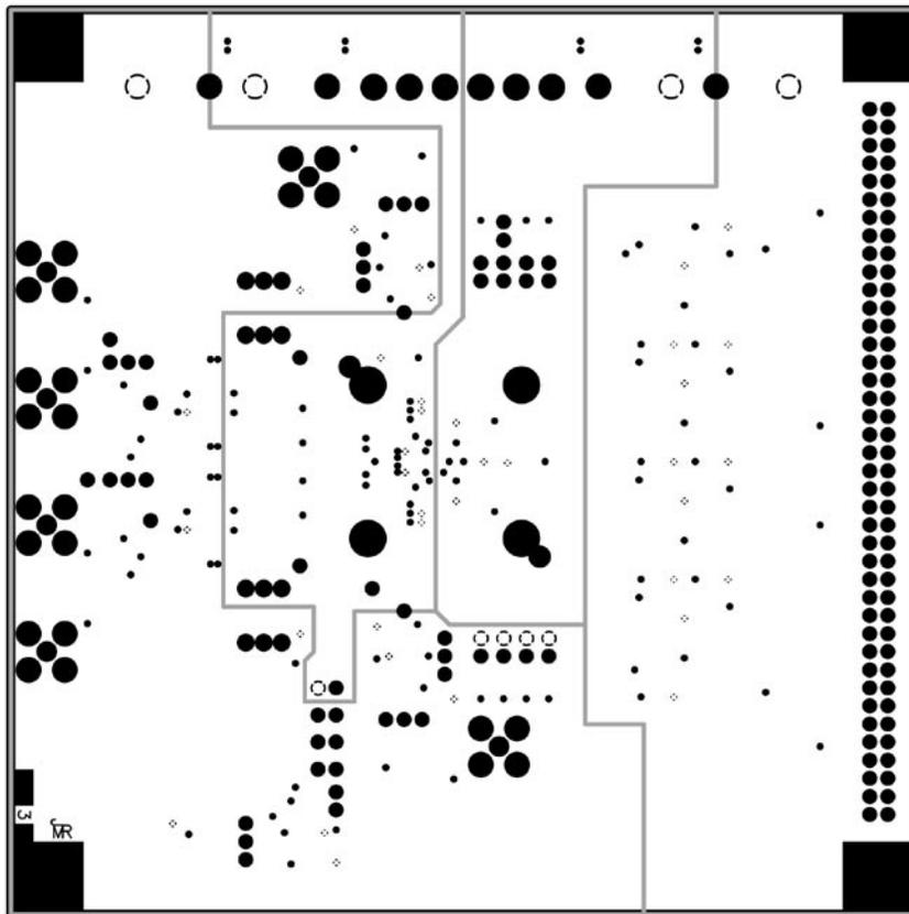
Figure 19. PCB Copper Pour
