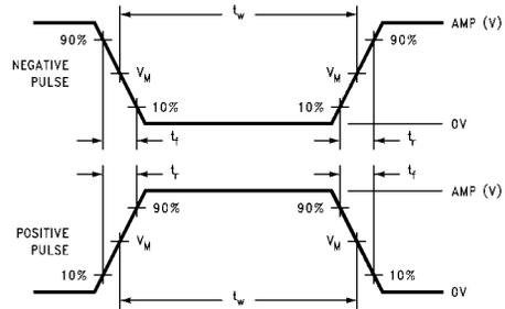
FIGURE 2.  $V_M = 1.5\text{V}$
