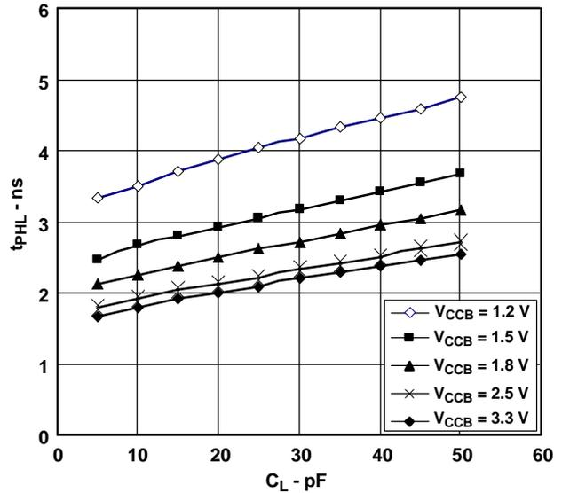
**TYPICAL PROPAGATION DELAY (A to B) vs LOAD CAPACITANCE,**
