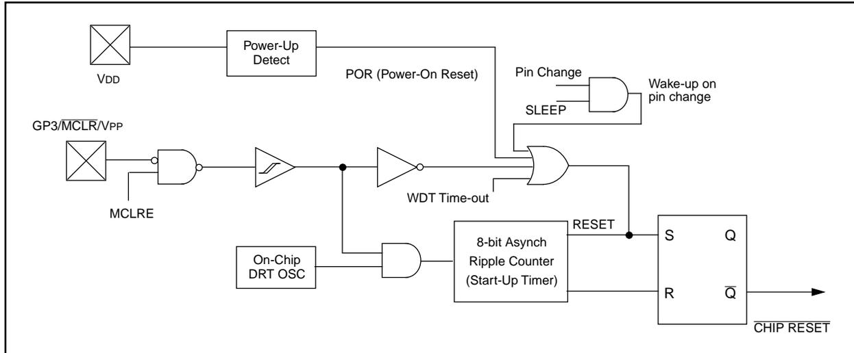
**FIGURE 8-9: TIME-OUT SEQUENCE ON POWER-UP ( $\overline{\text{MCLR}}$  PULLED LOW)**
