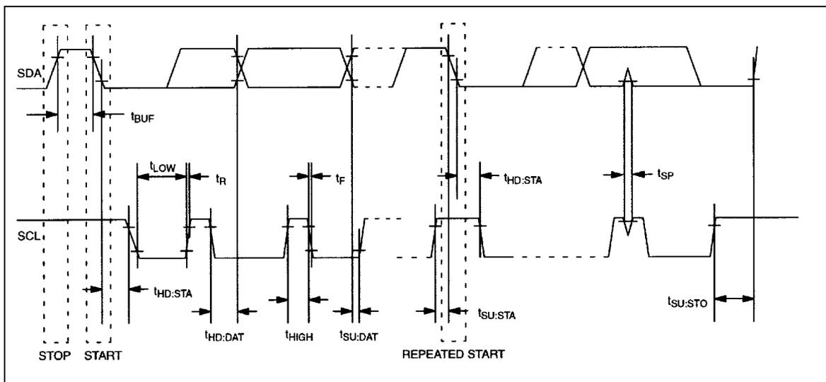
Figure 4. 2-WIRE SERIAL COMMUNICATION WITH DS1085
