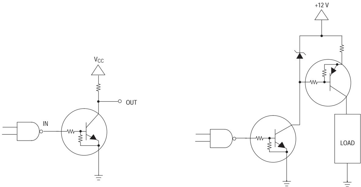
Figure 24. Open Collector Inverter:
