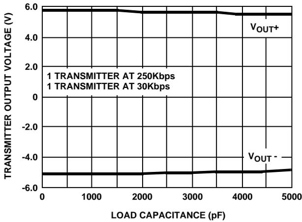
FIGURE 9. TRANSMITTER OUTPUT VOLTAGE vs LOAD CAPACITANCE
